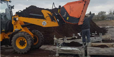
Absieben und Untermischen von Substraten in Transportboxen. Screening and mixing substrates in transport boxes.
