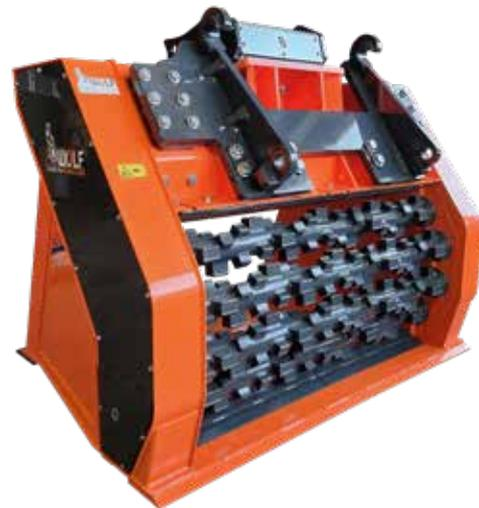
Ab der Terra-Star® Powerline 184 werden zwei Radialkolbenmotoren verbaut, die dafür sorgen, dass die TSP.184 in 20 - 30 Sekunden einen Inhalt von 2,2 m<sup>3</sup> durchsetzt. Um diese großen Kräfte nicht ganz ungezügelt zu lassen, ist zur Schonung der Lager und Ketten ein Schockventil vorgeschaltet.
