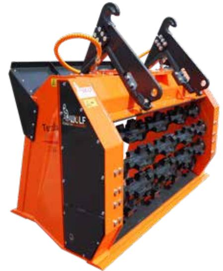
Die Lager sind wartungsfrei und in den Kettenkästen ist Fließfett, das durch die Bewegung der Schaufel und das Laufen der Kette an jeder Stelle für Schmierung sorgt. Somit muss der Terra-Star® nicht nachgeschmiert werden und ist wartungsfrei.
