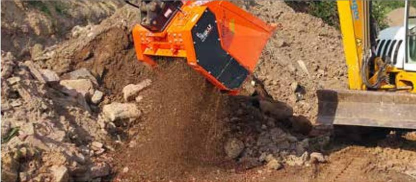
Mit der Mischwelle M80X werden Erdklumpen zerkleinert
