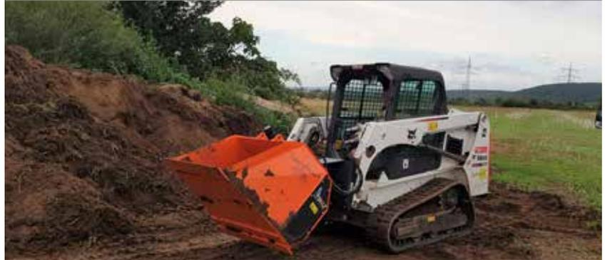
Aufgeben von Material auf die Siebmaschine, zerkleinert die Erdklumpen - hochwertiger Boden landet nicht im Siebüberlauf
