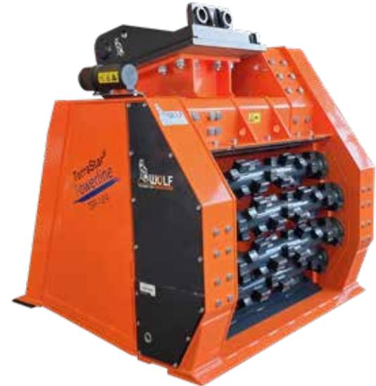
Terra-Star® Powerline steht für harte Dauereinsätze auf den Baustellen, Lagerplätzen oder Deponien. Der eingesetzte Radialkolbenmotor bringt aus dem Stand 2400 Nm Drehmoment und ermöglicht somit ein enorm starkes Anlaufen der Wellen, auch unter härtesten Bedingungen.
